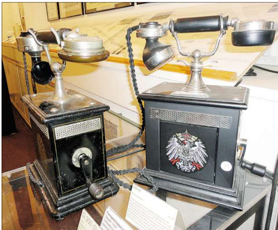
Original des Standardtischsprechers der Reichspost von 1905 (links) und der Nachbau als Designermodell der Deutschen Bundespost (rechts).
